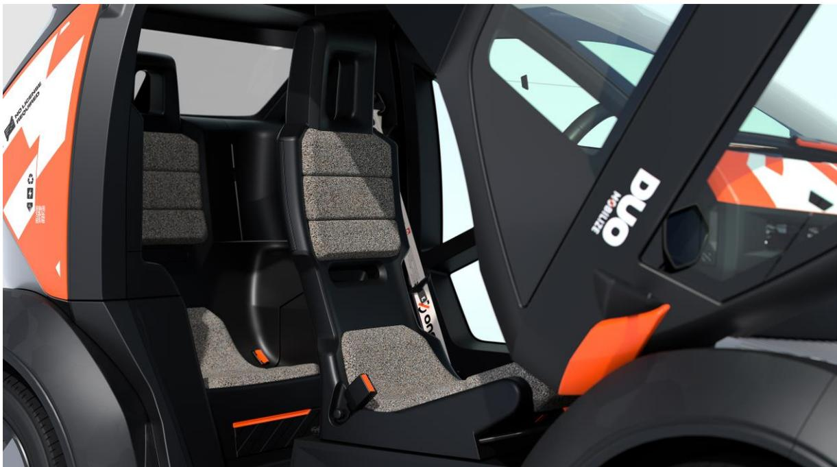
Le siège conducteur est coulissant sur 20 cm, de manière à faciliter l'accès à la place arrière. Deux espaces de rangement sont prévus de part et d'autre du siège avant pour transporter deux valises format cabine. La place arrière de Duo offre un espace suffisant pour accueillir confortablement un passager d'1,80 m.
